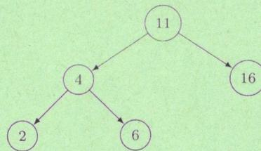
Abbildung 10: Baum nach der Operation 4 einfügen.
