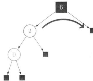
Abbildung 22: Left-Rotate über 0
