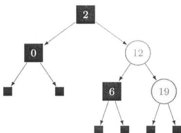
Abbildung 29: Left-Rotate über 6
