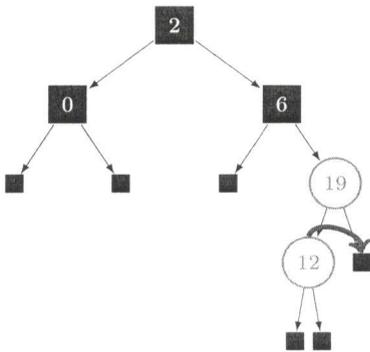
Abbildung 27: Einfüge-Operation von 12
