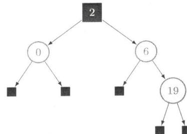
Abbildung 25: Einfüge-Operation von 19
