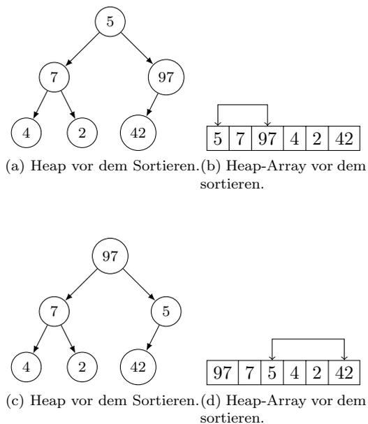
Abbildung 3: Aufbau des Heaps
