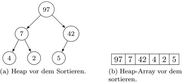
Abbildung 4: Fertig aufgebauter Heap
